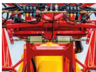
Balansbegrenzer met luchtcilinders vangt de diepe schokken op en brengt de spuitboom sneller naar zijn middenpositie.
