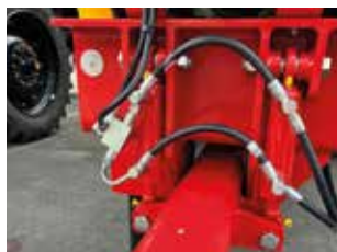
Hydraulische disselvering. Afgeveerd op stikstofbol.
