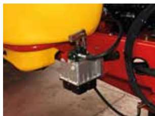
Goed bereikbare handpomp voor steunvoet.
