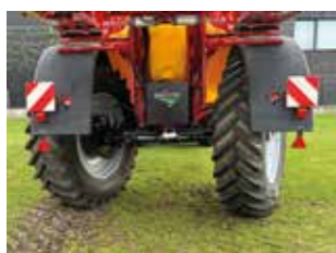
De automatische wielsturing wordt proportioneel bediend waardoor de wielen soepel in het spoor van de trekker volgen.
