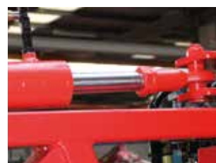
Variabele geometrie zodat de helling van het linker- of rechterdeel van de spuitboom apart kan worden bediend (niet negatief).
