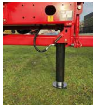
Hydraulische steunvoet: schuift automatisch terug; zowel te bedienen via handpomp of rechtstreeks op trekker.
