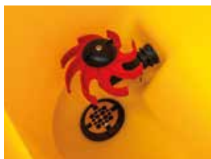
Dankzij de hogedrukmengkop onderin de mengtank wordt een kolk gevormd die het mogelijk maakt om gewasbeschermings- middelen in poedervorm snel en gemakkelijk te mengen.
