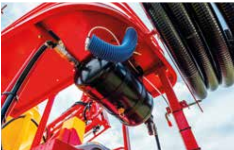
Tank met overdrukbeveiliging
