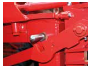
Alle elementen van de spuitboom zijn dankzij de regelbare haken vergrendeld, waardoor zwiep tot een minimum wordt gereduceerd.
